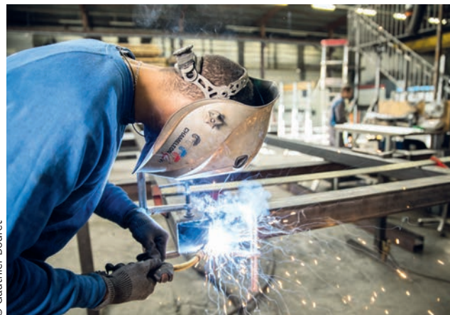
Les fumées de soudage émettent différentes substances pour lesquelles une captation est nécessaire.
